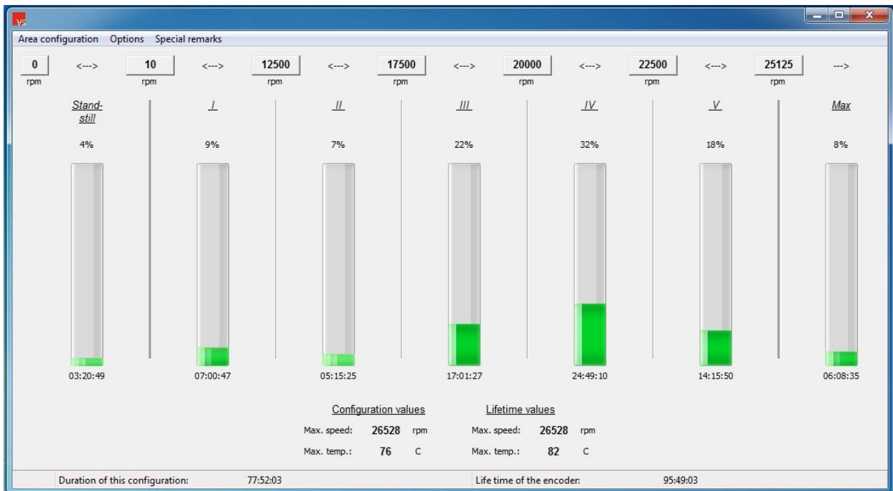
Betriebsstundenzähler – mittels Software ProCal ausgelesen
